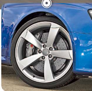
19インチアルミホイールが標準だが、オプションのスポーツパッケージには9.0J×20インチの5本スポークが含まれている。グレーのキャリアバーが、カーボンセラミック製フロントブレーキの証だ。
