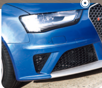
MLPプラットフォームの採用により、フロントのオーバーハングは旧型の950mmから860mmに短縮された。より均等な重量配分とレスポンスに優れたハンドリングの実現に寄与している。
