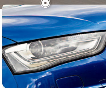
キセノンプラスヘッドライトを標準装備する。ライトの周囲に配置された留め金のように見えるLEDデイタイムランニングライトは、間違いなく特徴的である。
