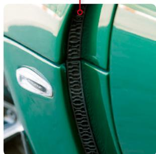
エキシージはトレッドが拡大され、それを収めるために広げられたフェンダーには拡大されたスリットが設けられた。強力なブレーキの熱を逃がすのに貢献する。
