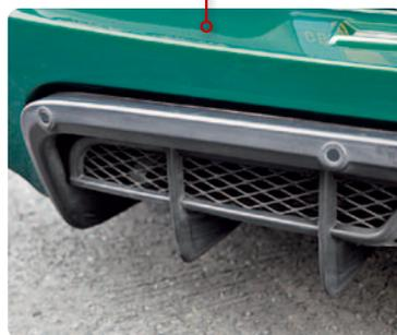
力強いリアディフューザーが、エキシージの空力パッケージを完成させている。エグゾーストには、サウンド調整と高回転での出力向上のための、バイパスバルブが採用された。
